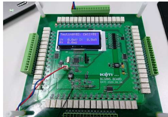
[리튬배터리 60셀 내부저항 측정 시제품] (관련 특허: 출원 10-2020-0047153)
